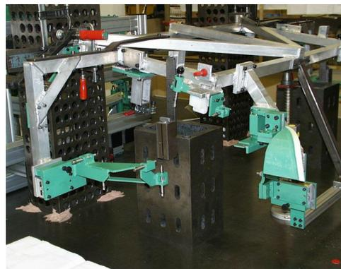
Kotflügel - Messvorrichtung
